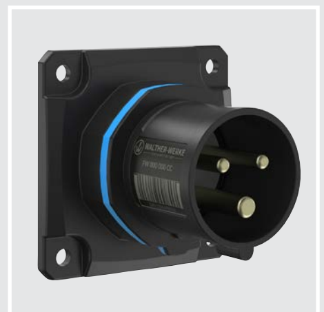
CEE NEO socles de connecteur de tableau, droit 3 x 16 A | 6 h | IP54 avec raccordement par vis ou cages à ressort
