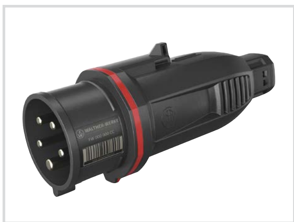
CEE NEO fiches One-Touch 5 x 16 A | 6h | IP54 avec raccordement par vis ou cages à ressort
