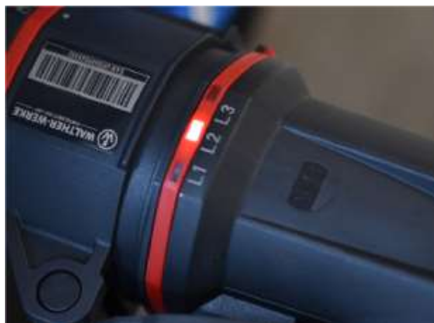
► Affichage LED du champ tournant et du contrôle des phases
